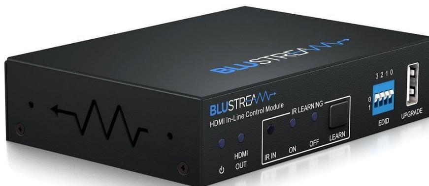
HDMI-контроллер HD11CTRL представляет собой автоматизированное решение для управления оборудованием в помещении, включая управление включением/выключением дисплея через CEC, RS-232 и ИК при обнаружении сигнала HDMI на входе.
